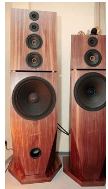
Каждая колонка Maestro Gold российской фирмы Aleks состоит из двух изолированных модулей. В нижнем установлена 18-дюймовый компрессионный НЧ-драйвер, а в верхнем — шелковые твитеры и среднечастотники с двумя диффузорами (премия «Продукт Года 2011» за инновационное решение)
